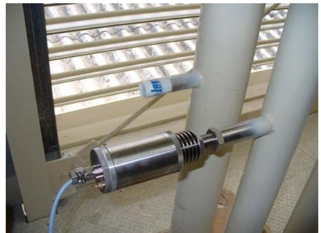
在煤粉喷射输送管上安装的流量计量系统MF 3000
